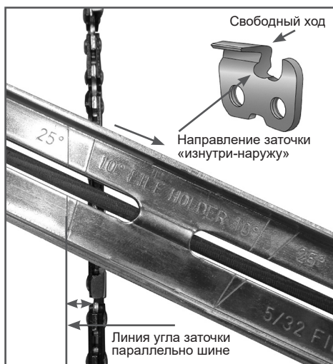
Рис. 22 Расположение линии угла заточки
